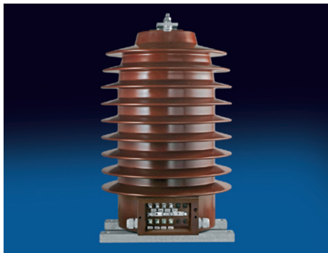
Transformadores de tensión para servicio exterior con pantallas características para extender la línea de fugas
